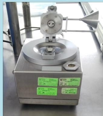
Se determinó la concentración de sólidos disueltos en la solución de sacarosa pura a través de el refractómetro.
