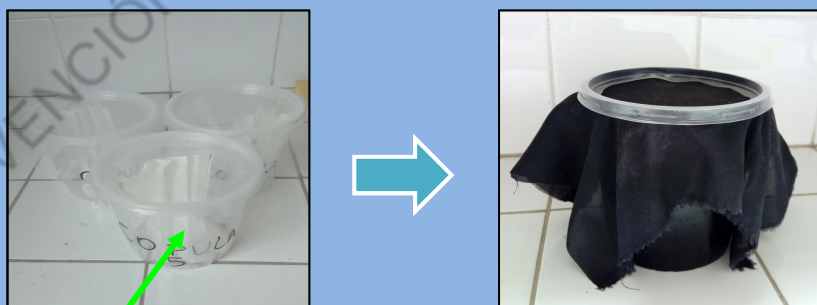
Fig.6. Recipientes plásticos transparentes cubiertos por tela negra en cuyo interior lleva papel manteca doblado en acordeón.
